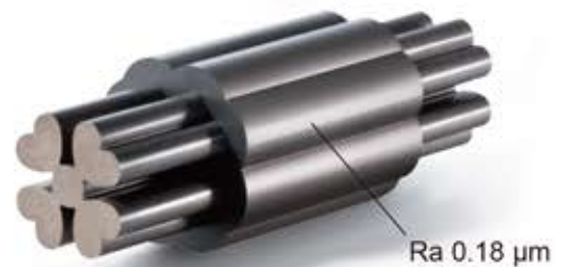
材料：鎢鋼 厚度 50 mm / 0.2 mm 黃銅線
